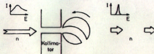
Abb. 10.2: Wirkungsweise eines mechanischen Monochromators. Nur Neutronen einer bestimmten Geschwindigkeit (Energie) können den rotierenden Festkörperzylinder auf dem durchgehenden Pfad passieren, alle übrigen werden absorbiert. Der Neutronenstrahl ist gepulst
